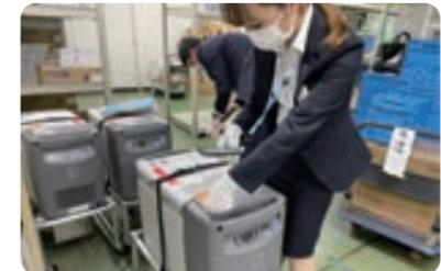
ワクチン配送の様子。搬送装置の温度逸脱がないかチェックしている。
